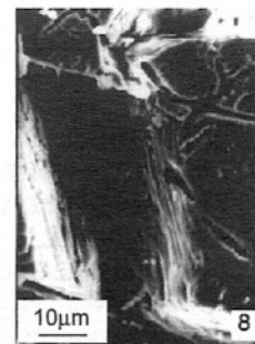
Foto 8 – Cristal de apatita hidrotermal anédrica (tipo 3) com sulcos de dissolução e com microporosidade. Amostra TA2a (MEV).
